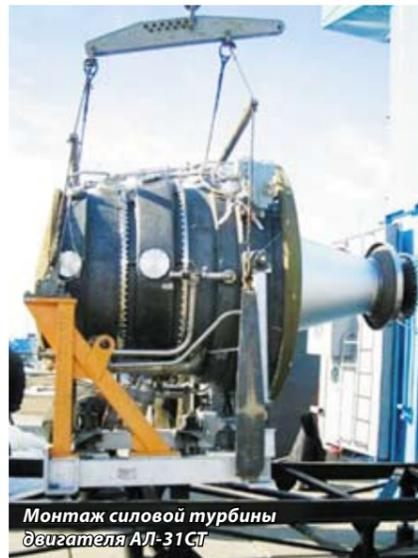
Монтаж силовой турбины двигателя АЛ-31СГ
