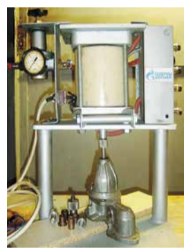
Действующий образец, изготовленный по рационализаторскому предложению «Устройство для запрессовки меднографитовых и бронзовых втулок»
