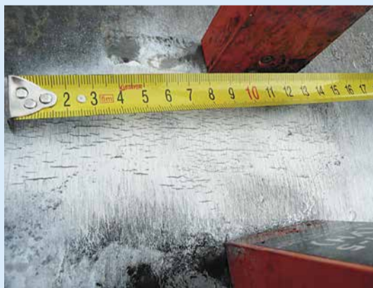
Дефект типа КРН
