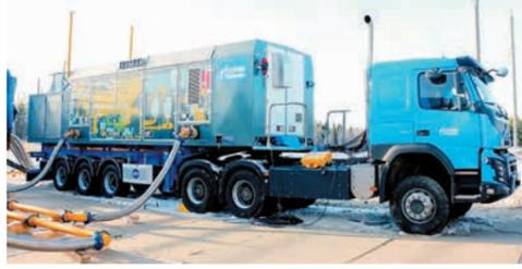
Перекачка газа с применением МКУ при ремонте линейной части магистральных газопроводов, эксплуатируемых ООО «Газпром трансгаз Москва» осуществляется на основании договора, заключенного с ООО «Газпром инвестпроект». Непосредственными исполнителями работ являются ООО «БашУралМонолит» и ООО «Газпром МКС».
