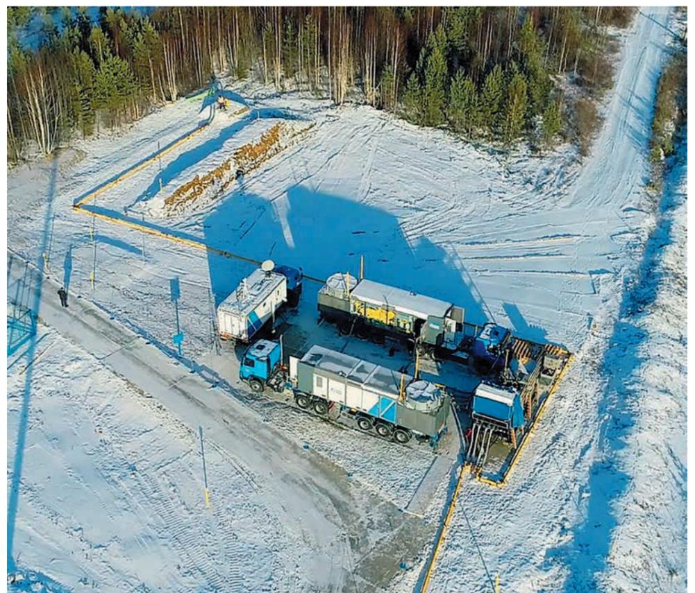
Мобильная компрессорная установка (далее МКУ) — это специализированное техническое средство, предназначенное для перекачки природного газа из ремонтного участка газопровода за отключающий
