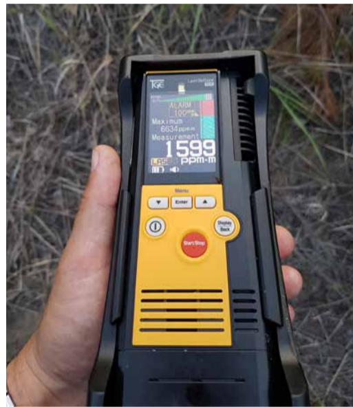
Показания газоанализатора на месте обнаружения утечки метана
