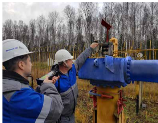
Идентификация места утечки с применением высокоточных переносных газоанализаторов и течеискателей
