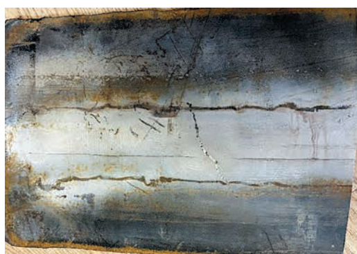
Темплеты дефектных участков технологических трубопроводов КС
