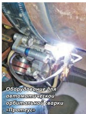
Оборудование для автоматической орбитальной сварки «Протеус»
