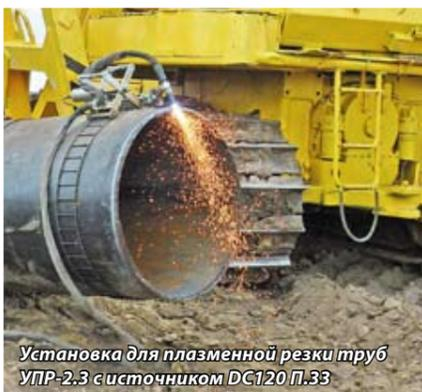
Установка для плазменной резки труб УПР-2.3 с источником DC120 П.33
