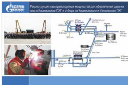
Проектом «Реконструкция газотранспортных мощностей для обеспечения закачки газа в Касимовское ПХГ и отбора из Касимовского и Увязовского ПХГ в объеме до 183 млн м<sup>3</sup> в сутки» предусмотрено строительство лупинга газопровода Касимовское ПХГ-КС «Путятино», газопровода Ямбург-Тула-2 с узлом редуцирования сброса газа в систему газопроводов Средняя Азия-Центр.
