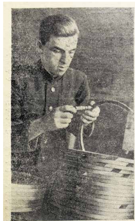
Начальник ЦРМ т. А. Сафронов проверяет маслосъемные кольца. Фото Юр. Иванова.
