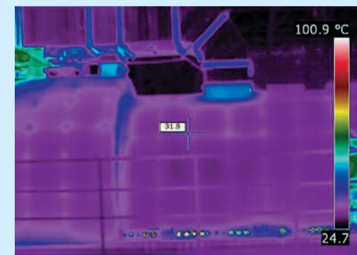
Распределение температуры по поверхности шумотеплозащитного кожуха
