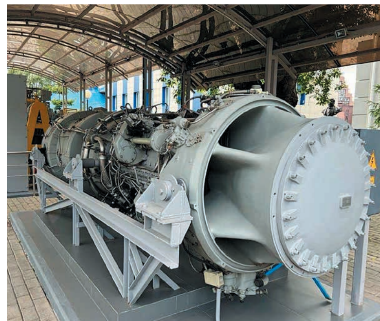
Газоперекачивающий агрегат НК-12СТ
