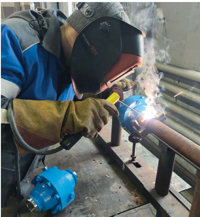
Центратор для стыковки трубы и шарового крана под сварку. Брянское ЛПМУГ
